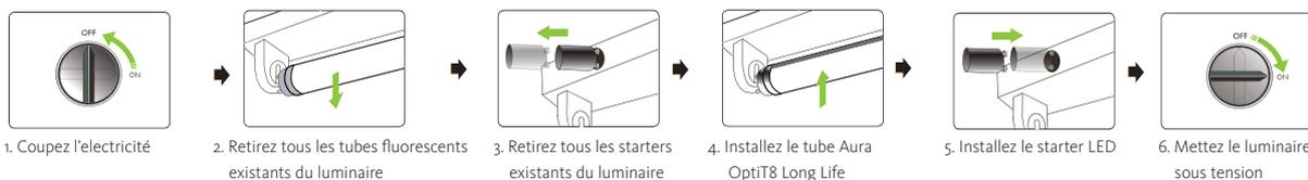
NOTE : Si un condensateur de compensation du facteur de puissance est présent dans le luminaire, il n'est pas nécessaire de le retirer mais vous devez savoir qu'il diminuera le facteur de puissance. Voir le tableau ci-dessous.
