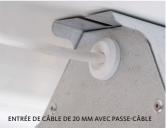
**BRANCHEMENTS:** Fixation en saillie ou sur hauban caténaire. Entrée de câble de 20 mm avec un passe-câble à chaque extrémité. Raccordement sur un bornier à cinq pôles pour 2,5 mm² max. Traversée de câble 5 x 2,5 mm<sup>2</sup>.
